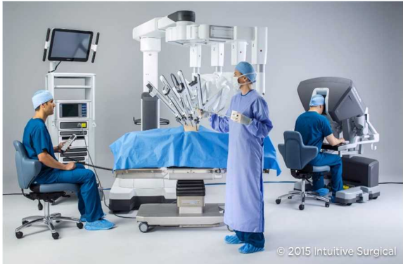
左：助手用モニター「ビジョンカート」 中：ロボット本体「ペイシェントカート」 右：操作台「サージョンコンソール」
